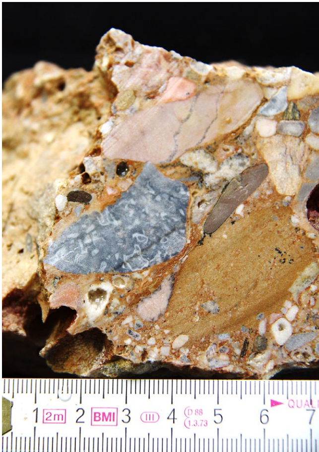
Abb. 10. Flache Schrägschichtung in einem Sandstein. Anschliff eines polymikten Konglomerats (vorwiegend Karbonatkomponenten, untergeordnet Kristallin) aus der Rohrbach-Formation.
