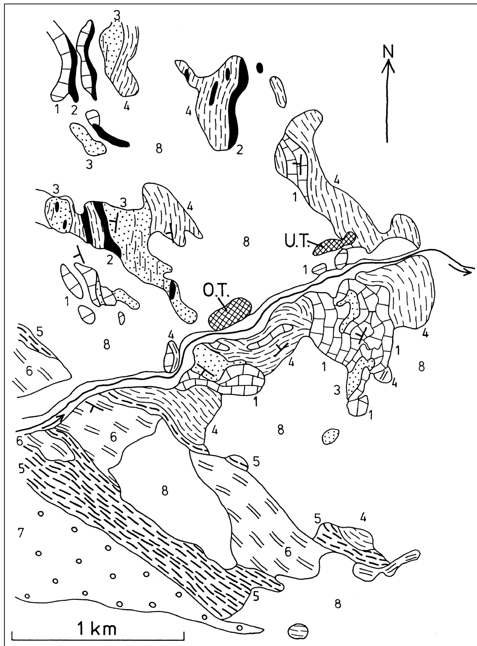
Abb. 1. Das Südennde des Drosendorfer Fensters (Blatt 8 Geras). 1 = Marmor; 2 = Graphitschiefer; 3 = Quarzit; 4 = Paragneis; 5 = Amphibolit; 6 = Gföhler Gneis; 7 = Granulit; 8 = Junge Deckschichten; U.T. = Unter Thumeritz; O.T. = Ober Thumeritz. Beschreibung im Text.
