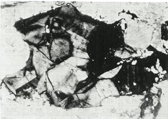
Abb. 7: Anomale Doppelbrechung in einem Grossular aus Zone C des Handstücks St-m. Nicols gekreuzt, Vergr. ca 160×.
