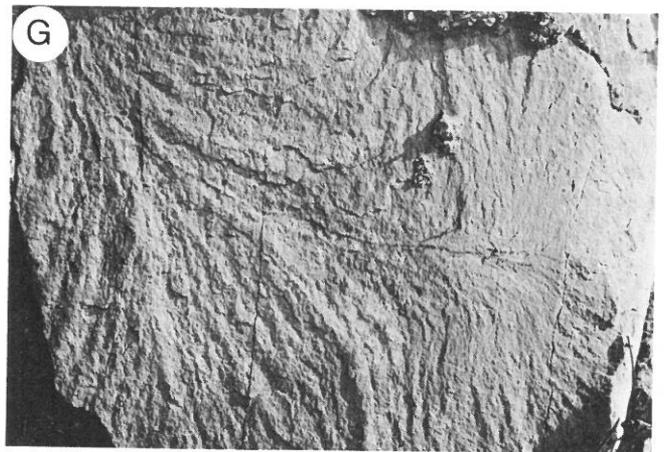
Abb. 7: Durch Sprengung hervorgerufene, sehr grobe federartige Struktur mit gekrümmter Achse; entlang den Wülsten im linken Bildteil blättert das Gestein in mm-dicken Schuppen ab, der etwas feinere Teil der Struktur (rechts) zeigt sehr steile Abgangswinkel der Federäste und Endwinkel an den Schichtflächen (parallel zur Bildlängskante) bis zu mehr als 90°. Bildausschnitt ca. 25x40 cm.
