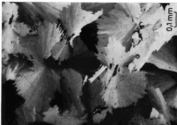
Abb. 15: Reinit: Radialstrahlrig angeordnete Ferberitbündel; die ursprüngliche Orientierung (parallel zu den Bildrändern) ist noch schwach angedeutet. Anschliff, Nicols +.
