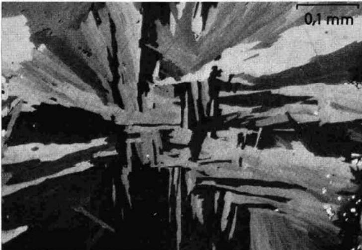
Abb. 14: Reinit: Ferberitleisten, nach den kristallographischen Richtungen des ehemaligen Scheelitkristalles orientiert; Übergang zu radialstrahlig angeordneten Bündeln an den Bildrändern. Anschliff, Nicols +.
