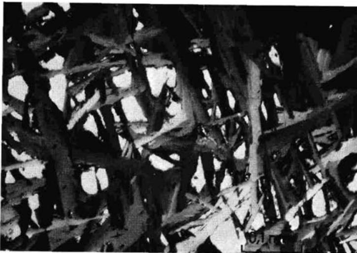
Abb. 20: Orientierte Ferberitleisten mit Anthoinit (weiß) in den Zwischenräumen. Der Anthoinit ist durch Umwandlung aus Scheelit hervorgegangen, der seinerseits von der Reinitisierung verschont geblieben ist. Anschliff, Nicols +.
