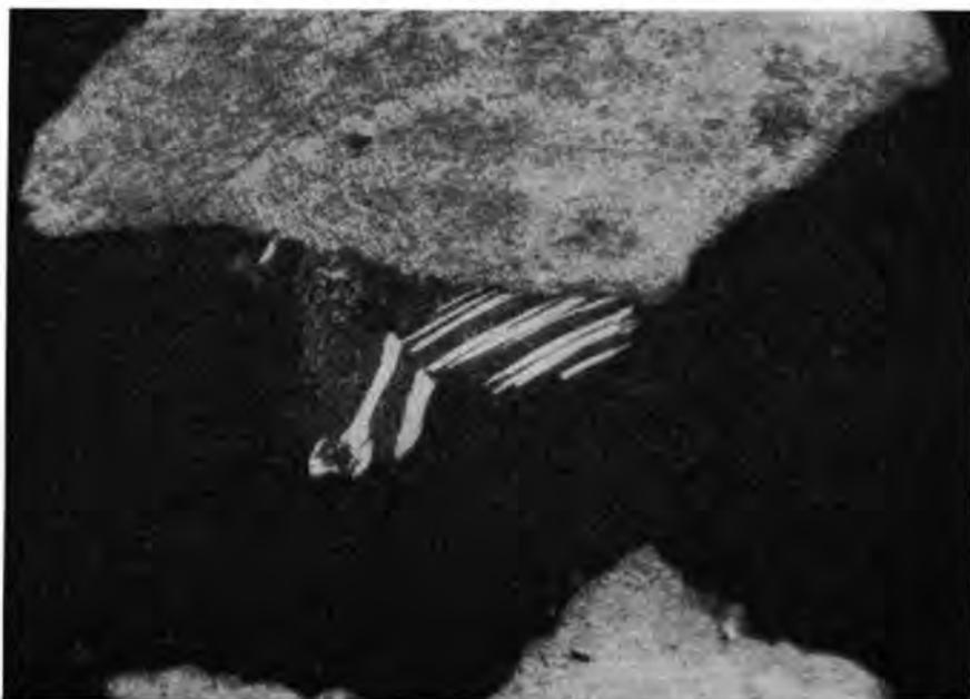
Abb. 16: Vergr. 40 $\times$ . Markasit (weiß) ist mit Magnetkies (geätzt = dunkelgrau) verwachsen. Kupferkies (geätzt = hellgrau) und Quarz (schwarz) umschließen die Markasit-Magnetkies-Verwachsung.
