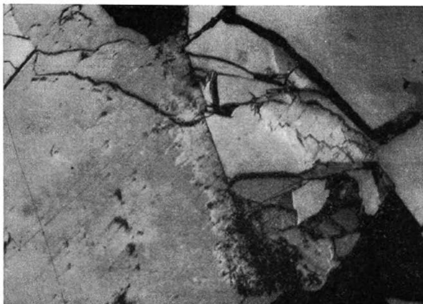
Abb. 21: Vergr.  $80\times$ . Pentlandit (hellgrau) stößt an ein Pyritkorn (weiß). Die dem Kupferkies (grau) zugekehrten Pentlandit-Spitzen führen weiße Millerit-Säume. Diese Millerit-Säume sind unter hydrothermalen Bedingungen in Millerite umgewandelte ehemalige Pentlandite.
