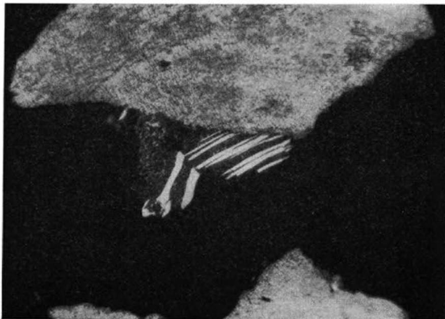
Abb. 16: Vergr. 40×. Markasit (weiß) ist mit Magnetkies (geätzt = dunkelgrau) verwachsen. Kupferkies (geätzt = hellgrau) und Quarz (schwarz) umschließen die Markasit-Magnetkies-Verwachsung.
