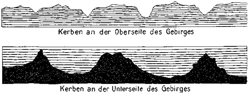
Fig. 2. Die Erosionskerben der Oberfläche lösen die Schichtzusammenhänge und führen bei weiteren Deformationen Erleichterungen und Leitungen für Verbiegungen und Verschiebungen herbei.
