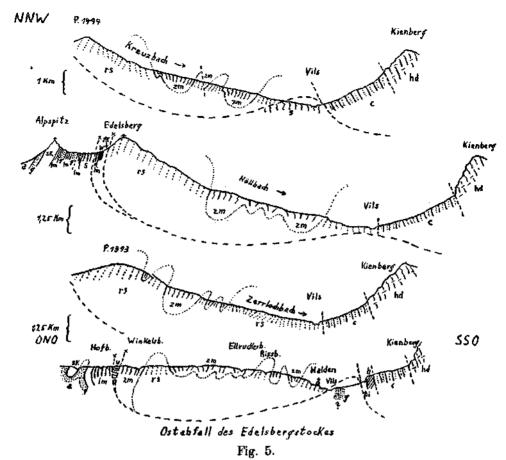
Profilserie durch den mittleren und östlichen Teil des Edelsbergstockes 1:40.000 u Apt, g Gargasien, sk Seewerkalk, lm Leistmergel, s Stadschiefer, os Oberzollbrücker-Sandsteine; w Wildflysch, fk Flyschkalkzone, q Quarzitzone; u ultrahelvetischer Schubfetzen; rs Reiselsberger Sandsteine, zm Zementmergel; hd Hauptdolomit, h Hierlatzkalk, ti Tithonkalk, c Cenoman.
