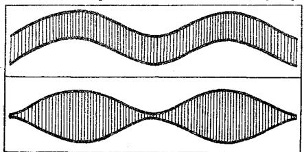
Fig. 23. Im oberen Schema ist das Mittelfeld zwischen den verbogenen Faltensträngen gleich breit, im unteren sind durch Verschiebung im Streichen Verengerungen und Verbreiterungen des Mittelfeldes bei gleichem Flächeninhalt entstanden.
