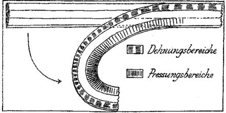
Fig. 19. Vergleiche dazu die Abbildung eines verbogenen homogenen Streifens nach B. Sander. Verhandlungen 1909, Seite 359.
