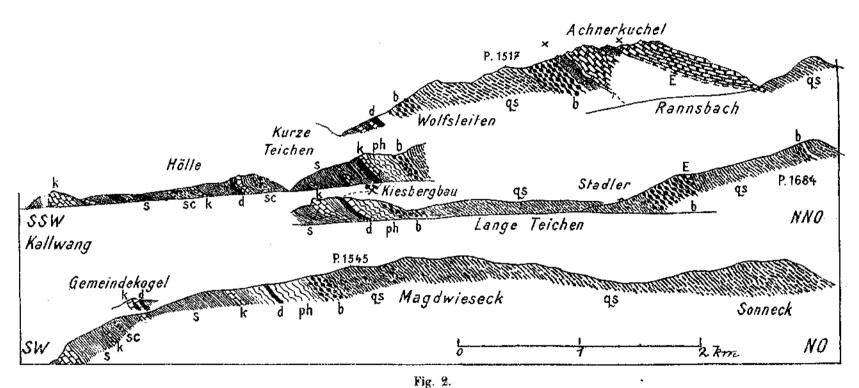
s graphitführende Karbonschiefer, so konglomeratische Schichten in denselben, k Kalke des Graphitkarbons, d Grünschiefer, pk Phyllit, b Blasseneckserie, qs feinschichtige Grauwackenschiefer, E erzführender Silur-Devonkalk.  $\times - \times$  Einzelheiten dieses Profilteils siehe Fig. 3.
