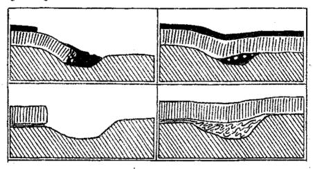
Fig. 9. Im oberen Fall Ausstopfung einer Kerbe durch abgerutschtes Hangendmaterial einer Schubmasse, im unteren Fall durch angeschopptes Liegendmaterial. Die Bewegung der Schubmassen erfolgt von links gegen rechts.
