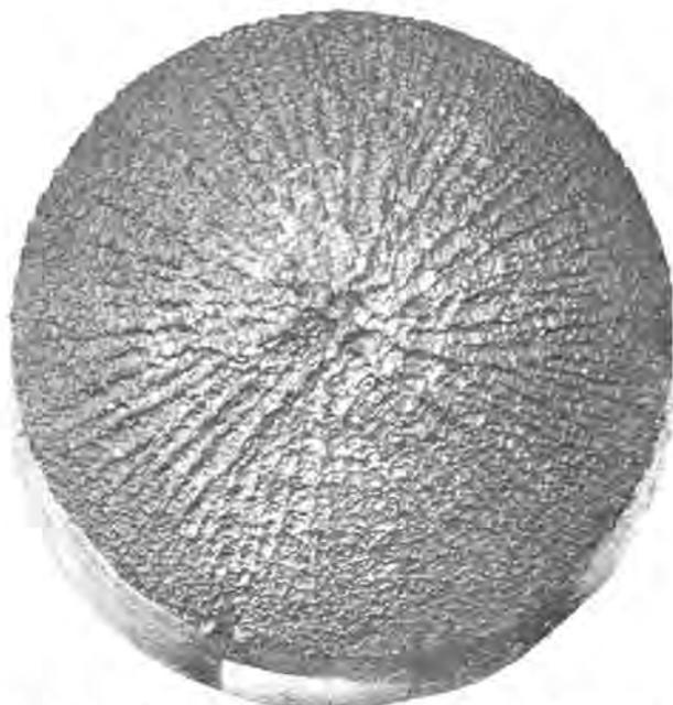
Versuch an Colophonium. Mündung des Dampfrohres auf 22 cm an die Scheibe herangerückt, welche mit 150 Touren per Minute rotirte. Dauer der Einwirkung: 20 Secunden. Natürliche Grösse.
