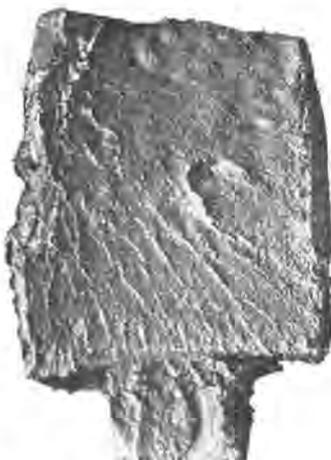
Rechteckig prismatischer Colophoniumkörper auf Holzstiel. Der Dampfstrahl wirkte in 20 cm Entfernung, während das Prisma in einer zur Stossrichtung senkrechten von links nach rechts (150 Touren per Min.) gedreht wurde. Dauer 15 Sekunden. Auf den Prismenflächen sind gegen den Rand verschobene Sterne und Gruben entstanden. Das obere Drittel des Prismas ist abgebrochen. Vergrößerung: 3:2.
