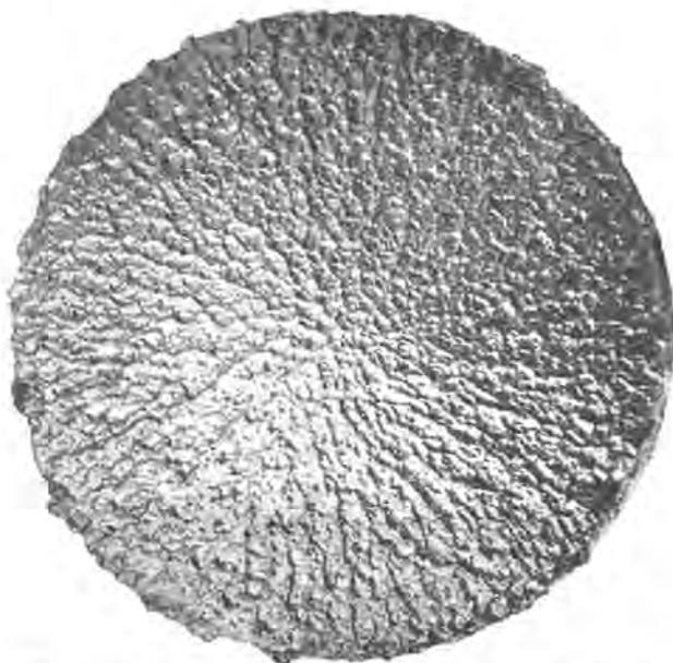
Versuch an Colophonium. Mündung des Dampfrohres in 21 cm Entfernung; der Strahl trifft die Scheibe unter einem Winkel von 40°. Rotation 150 Touren per Minute. Dauer der Einwirkung: 20 Secunden. Natürliche Grösse.
