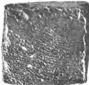
Versuch an Colophonium. Fläche eines rotirten Prismenbruchstückes, im Halbschatten der Wirkung des Dampfstrahles, mit Kerbenbildung. Vergrösserung: 3:2.
