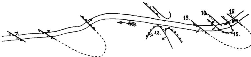
Das Gehänge bei der Haltstelle Halwang der Staatsbahn ist eine durchnässte Moräne, die bei anhaltendem Regen leicht in Bewegung kommt und bei den Ueberschwemmungen Ende Juli 1897 bedeutende Verkehrsstörungen verursachte.
