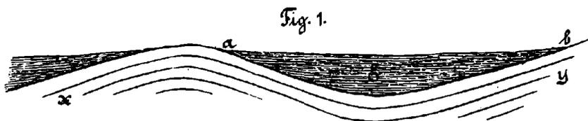
und die Vertiefung zwischen Mittelschenkel und Muldenschenkel aufgefüllt mit einer übergreifend lagernden Schichtfolge E. Er denke sich weiter, dass die Falte XY in ihrer Bildung fortschreitet (Fig. 2.), wodurch der Punkt a dem Punkte b genähert, um die eingeschlossene Masse E in der hausbackensten Art gestaut wird.
