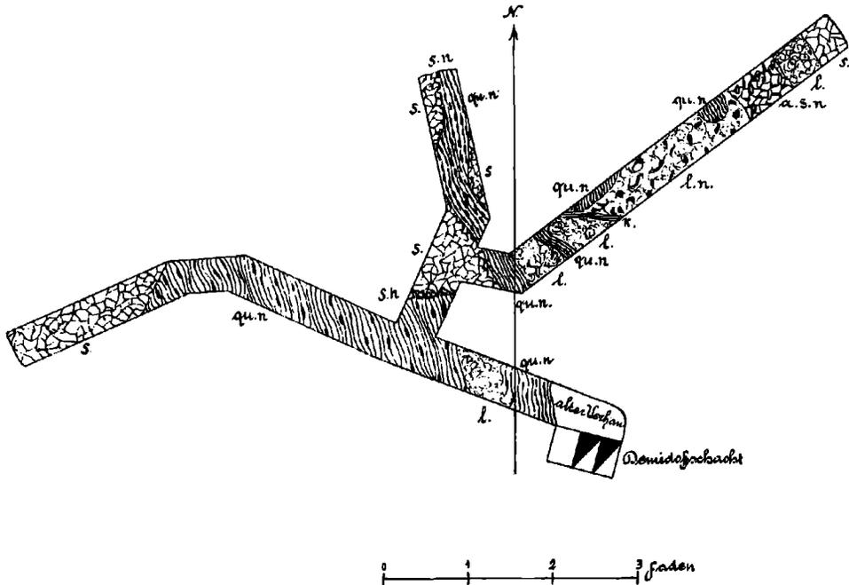
Grundriss der 19 Faden-Strecke des Demidoff-Schachtes der Petrofsky-Grube.
