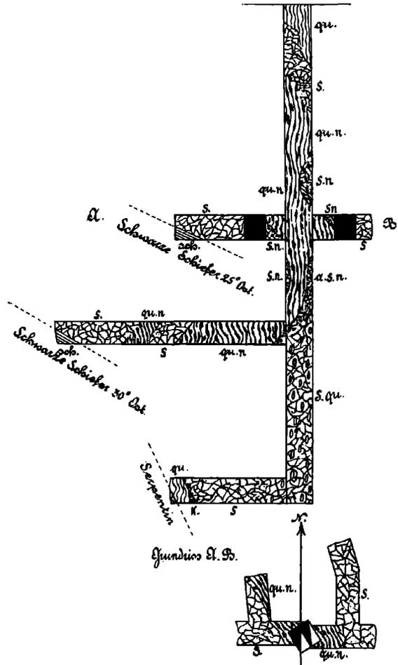
Profil des Schurfschachtes „Nord I“ der Petroskygrube.
