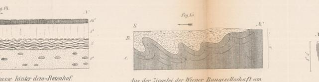
Sandgrube an der Lauerstrasse hinter dem Rothhof. a. Blaus. b. Löss mit kleinen Geröllen aus O. oder Wiener Sandstein an der Basis. c. Eine Lage Basaltsteine. d. Drei geschichtete Lagen von gelbem Sand u. Moos. e. Tegel in grosser Anzahl wechselnd und wellenförmig gebogen. f. Feiner, glimmeriger Sand mit unregelmässigen Sandsteinconcretionen.
