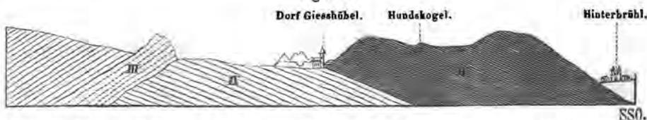
I Wiener Sandstein. II Hydraulischer Kalkstein. III Rauchwacke. IV Guttensteiner Kalk. V und VI graue nicht bituminöse Kalksteine. VII Jura-Aptychen-Kalk. VIII Dolomit und graue bituminöse Kalksteine. IX Werfener Schiefer.
