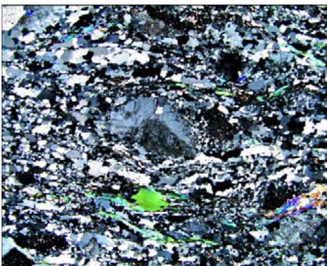
Abb. 53. Dünnschliff-Foto des Bittescher Gneises aus dem Steinbruch Weingartner bei Harmannsdorf mit Kalifeldspat, Plagioklas, Quarz, Biotit, Muskovit und etwas Chlorit. Bildbreite ca. 15 mm.
