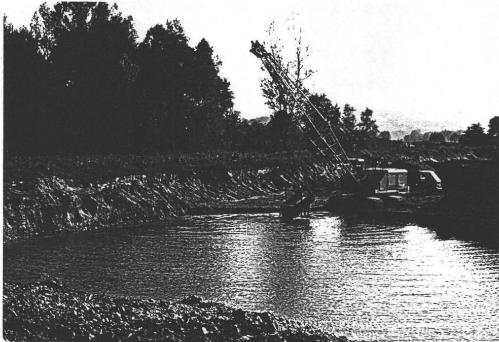
Abb. 14: Kiesabbau 14=203 mit dem Seilzugbagger und zugehörige Sortieranlage
