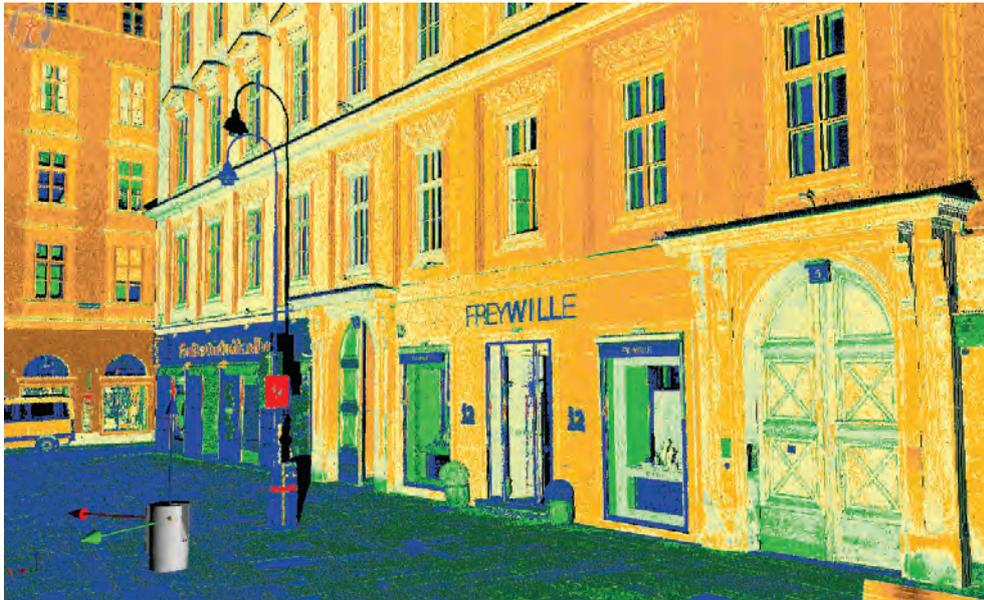
Abb. 5: Eine 3D Punktwolke nach Reflektivität eingefärbt
