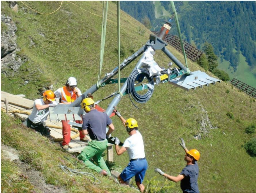
Abbildung 8: Dreibein-Prüfeinrichtung für Abnahmeprüfungen (WLV Imst).
