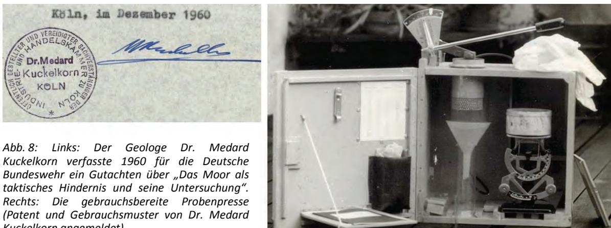
Abb. 8: Links: Der Geologe Dr. Medard Kuckelkorn verfasste 1960 für die Deutsche Bundeswehr ein Gutachten über „Das Moor als taktisches Hindernis und seine Untersuchung“. Rechts: Die gebrauchsbereite Probenpresse (Patent und Gebrauchsmuster von Dr. Medard Kuckelkorn angemeldet).
