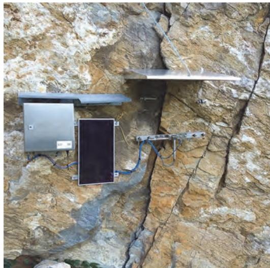
*3-D Fissurometer mit Funkübertragung*
