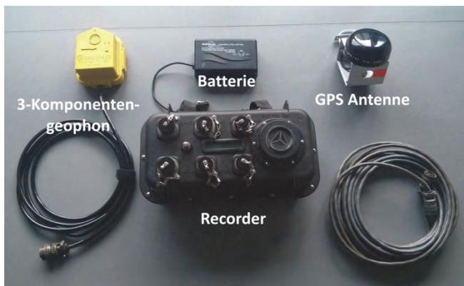
Abb. 2. Seismisches Messsystem
