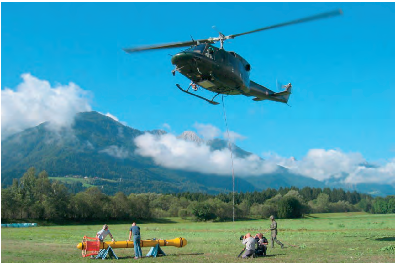
Abb. 3. Hubschraubergeophysik der Geologischen Bundesanstalt. © Geologische Bundesanstalt.
