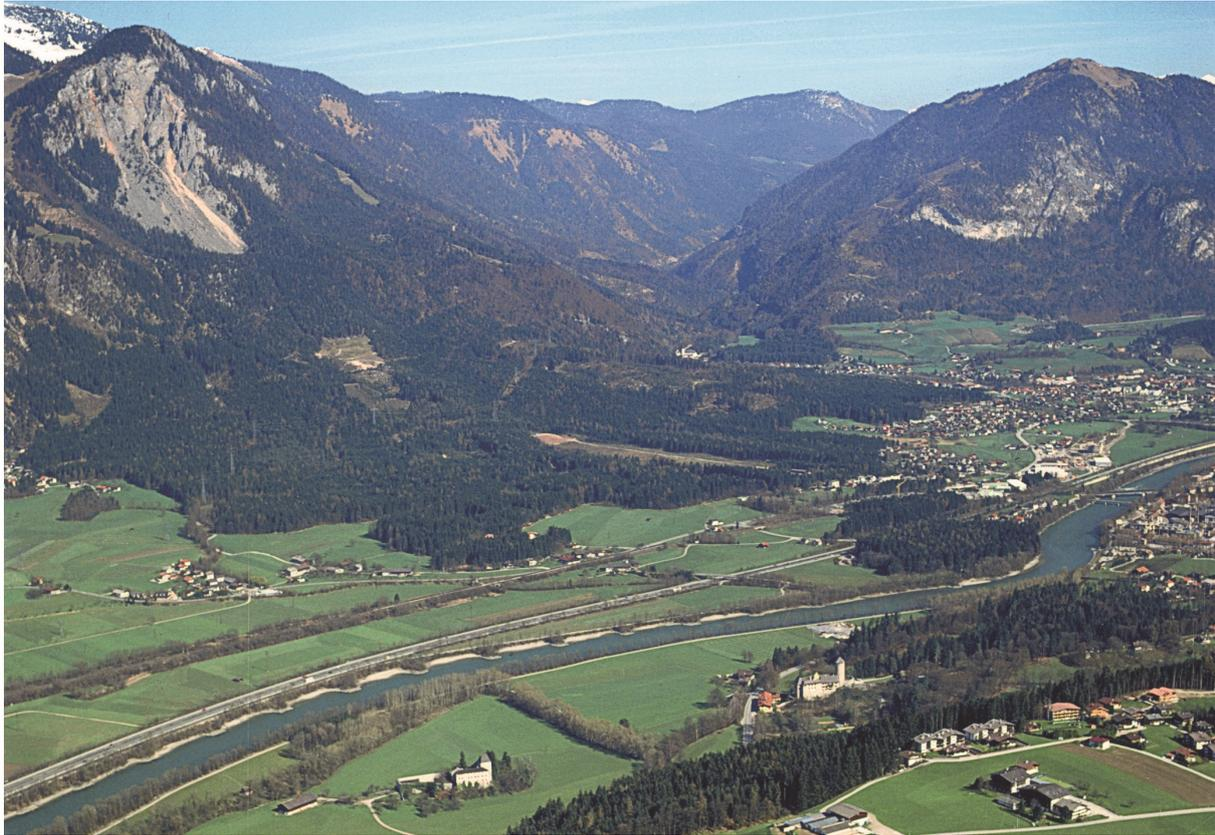
Abb. 1: Der Bergsturzbereich vom Pletzachkogel mit der römzeitlichen Abbruchnische (links oben), dem Ablagerungsgebiet auf der Innalsole (größtenteils bewaldet) und dem Stauraum (linke untere Bildhälfte) mit den Burgen Lichtwert und Matzen. (1.4.2001)
