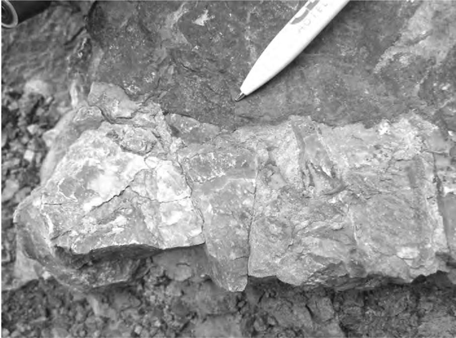
Abb. 7: Teilweise zu Siderit umgewandelte Basisbrekzie vom Steirischen Erzberg. Die metasomatische Front verläuft mitten durch einzelne Kalkkomponenten.
