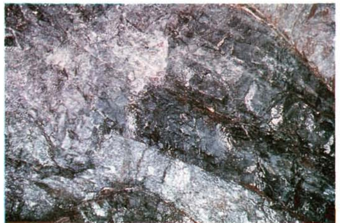
Abb. 15. Abgerissene Bank von Gutensteiner Kalk und Dolomit, tektonisch eingeschoben im hangenden Wettersteinkalk und -dolomit. Nordtrum, Station 3524.
