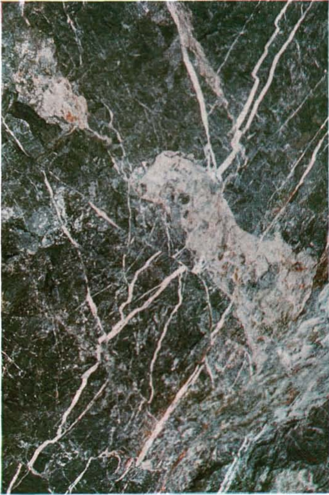
Abb. 13. Zwei Generationen von Kalzit-Kluftfüllungen, nachträglich durch tektonische Bewegungen zerlegt und versetzt.
