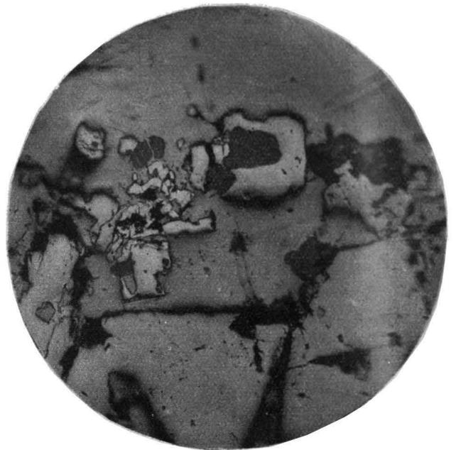
Bild 3. Erzstufe von Nogaré bei Trient. Perimagmatische As-Au-Vererzung. 200  $\times$  vergr. Opakilluminator von E. Reichert-Wien.
