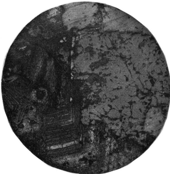
Bild 2. Erzstufe aus Raibl, Julische Alpen. Pliozäne apomagmatische, 60  $\times$  vergr. Opakilluminator von E. Reichert, Wien, mit  $\text{HNO}_3$  geätzt.
