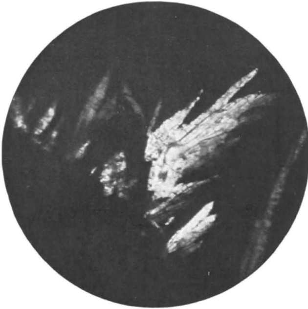
Abb. 17. Barytnadeln der Partie h der Erzstufe Abb. 15, sitzen einer Blende region auf und ragen nach oben in dichten, als Gel ausgeschiedenen Flußspat hinein.
