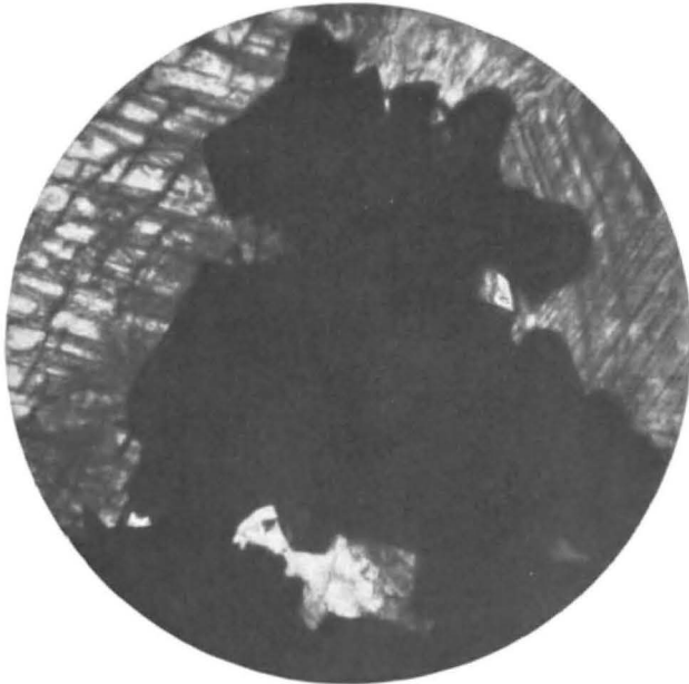
Abb. 22. In grobspätigen Calcit dringt kristalliner Flußspat (schwarz) vor. In diesem eingeschlossene Reste von Calcit. Schönes Bild reiner Metasomatose
