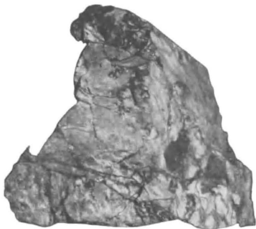
Abb. 13. Die Klüfte des lichten Wettersteinkalkes sind mit wenig dichtem Bleiglanz ausgefüllt. Klüftvererzung
