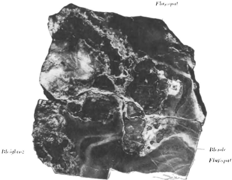
Abb. 21. Eine durch die Flußspat-Blende-Vererzung in Resorption begriffene ursprüngliche Bleiglanz-Wettersteinkalk-Breccie (vgl. Abb. 14). Bleiglanz (unverändert) in Resorptionsresten, die übrigen dunkeln Partien sind dunkelgrauer Flußspat, in welchem partienweise isolierte Blende-Kristalle eingeschlossen sind, welche zu lichtgelben Schleiern oder Bändern zusammentreten können. Die weißen Partien sind Calcitreste im Flußspat.
