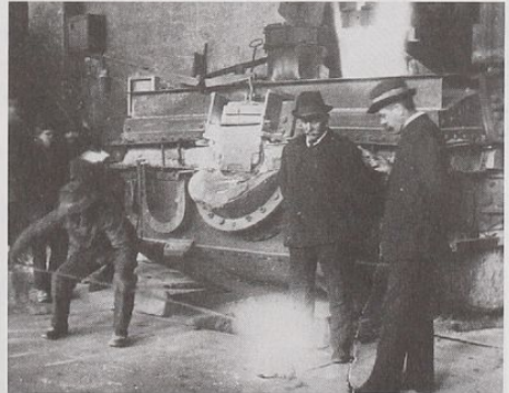
Abb. 1: 5,5-t-Elektrolichtbogenofen, Bauart Héroult, im Stahlwerk der KESTAG in Ferlach; Abstichseite (Gießen einer dem Stahlbad entnommenen Probe), wahrscheinlich um 1912.
