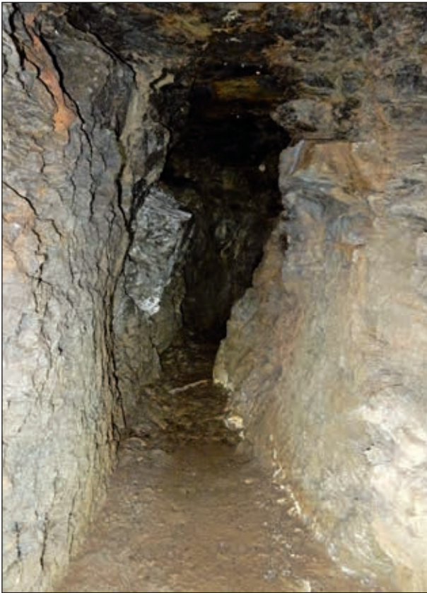
Abb. 30: Straßegg; unbenannter Stollen; handgeschrämte Ortsbrust (Foto WEBER)
