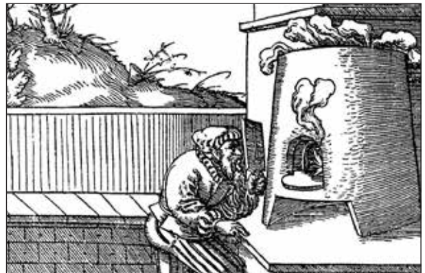
Abb. 1: Probierofen aus Ton. Der Probierer beobachtet durch einen Spalt im Brett, das ihn vor der Hitze schützen soll, die Vorgänge im Ofen. (Georg Agricola 1556/1978)
