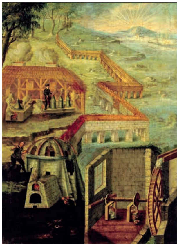
Abb. 1: Schmelzofen zur Arsenikgewinnung und Blaufarbenerzeugung mit gewinkeltm Kondensationskanal sowie Hütte mit Sublimationskesseln zur Reinigung des Arsensulfids bzw. der Herstellung von Arsensulfiden, vermutlich vom Maler Johann Weiß, um 1780, Öl auf Leinwand, ca. 50,5 x 72,5 cm. Quelle: Salzburg Museum, Inv.-Nr. 560 i-49.
