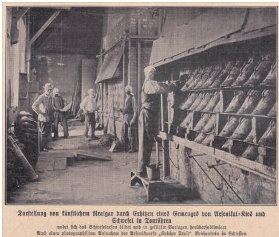
Abb. 4: Sublimation von künstlichen Arsensulfiden in Tonröhren und eisernen Retorten in der Arsenikhütte von Reichenstein (heute Złoty Stok in Polen), vor 1908. Quelle: KRAEMER 1908/09, wie Anm. 24, 171.
