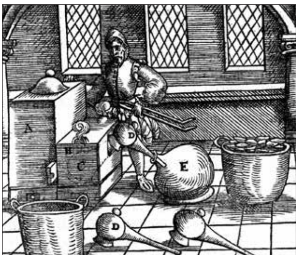
Abb. 6: Brennen von Scheidewasser. Die Retorten sind aus Glas gefertigt. (Lazarus Ercker 1580)
