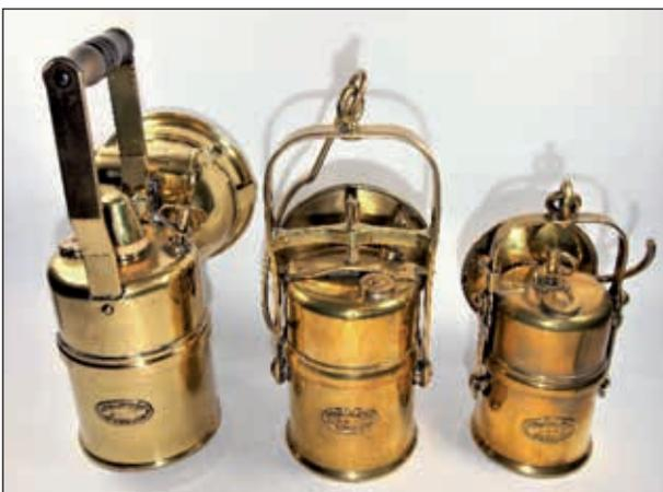
*Abb. 8: Acetylen-Lampen.: Hersteller Friemann & Wolf, Zwickau. Modell 909c Gr.1 1920; 905a Gr.2 1930; 850 Gr.3 1925.*
