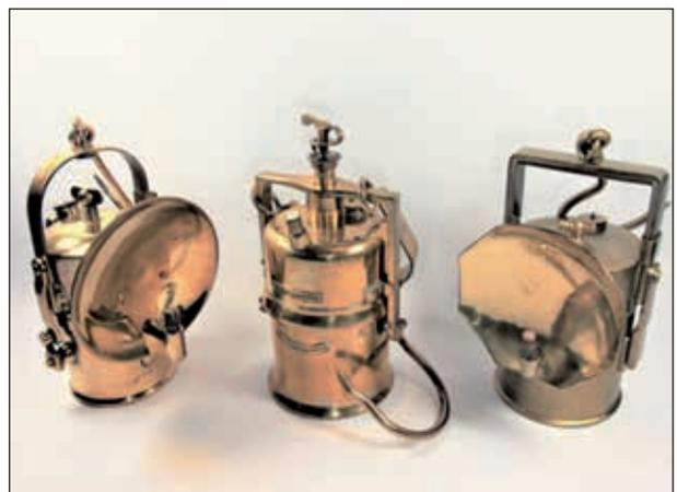
*Abb. 9: Acetylen-Lampen, Mod. 213 Kämpe & Thonig, Dresden 1913; 851 F & W Zwickau 1912; Hersteller unbekannt, 1930*
