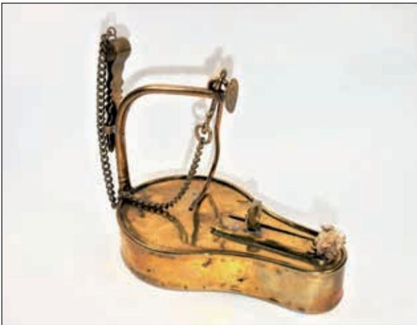
*Abb. 6: Geschlossene Froschlampe für Ölbrand (Rüb-, Distel- oder Olivenöl), Hersteller unbekannt, Schemnitz 1860.*
