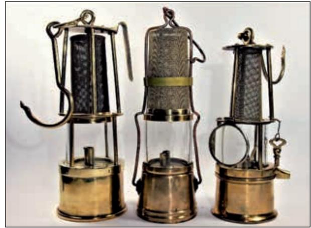
**Abb. 11: Benzin-Sicherheitslampen: Kubala & Comp. Mährisch-Ostrau, 1898; Lampe mit Aachener Verschluss Kubala 1897; Mod. 620 F&W Zwickau, 1925 mit bikonvexer Linse**
