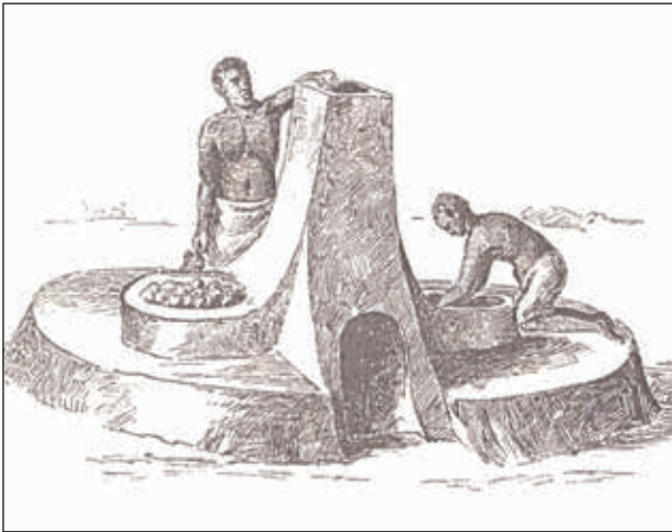
Abb. 2: Schmelzofen zur Raseneisenerzverhüttung bei den Baluba
