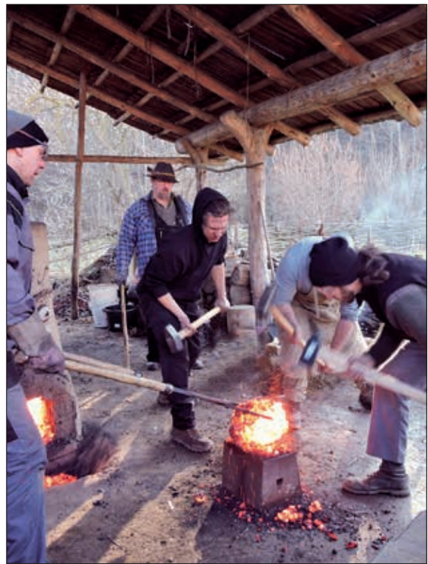
Abb. 13: Eine Eisenluppe mit einem Gewicht von etwa 8 kg wird unmittelbar nach der Entnahme aus dem Schachtofen bei einer Schweißtemperatur von über 1240 Grad durch Schmiededen verdichtet, um Schlackenreste auszuschleiden
