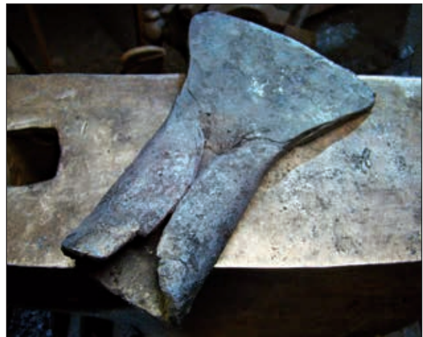
Abb. 15: Das „authentisch“ erzeugte Eisen wurde zu eisenzeitlichen Werkzeugtypen verarbeitet; bei manchen Stücken war der Kohlenstoffanteil im Material so hoch, dass sie gehärtet werden konnten; im Bild ein klassisches Tüllenbeil der Latènezeit
