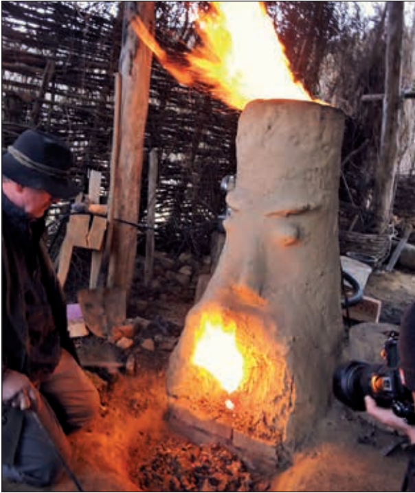
Abb. 12: In Zusammenarbeit mit der Arbeitsgruppe Archäotechnik Elsarn wurde Raseneisenerz in einem Schachtofen aus Lehm verhüttet, wobei im Zuge von zwei Ofenreisen an die 14 kg Eisen erzeugt werden konnten (Foto: W. F. A. Lobisser)
