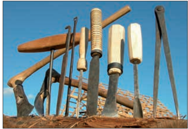
Abb. 7: Eisenwerkzeuge nach keltischen Vorbildern, die bei den Aufbauarbeiten im Freilichtmuseum in Schwarzenbach zum Einsatz kamen; von links nach rechts: Tüllenbeil, Lappendechsel, Löffelbohrer, Hakengriffmesser, Rindennadel, Pfriem, Stemmbeitel, Schnitz Eisen, Zirkel, im Vordergrund Ziehmesser (Foto: W. F. A. Lobisser)
