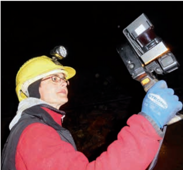
Abb. 10: Diana Höfelbarth (TU Bergakademie Freiberg) bei der Hohlraumaufnahme mit dem Handlaserscanner ZEB-REVO.
