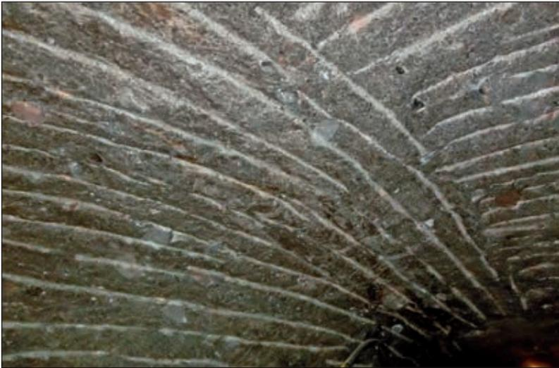
**Abb. 3: Schräm Spuren im Salzbergbau Hallstatt (Foto J. Friml)**
