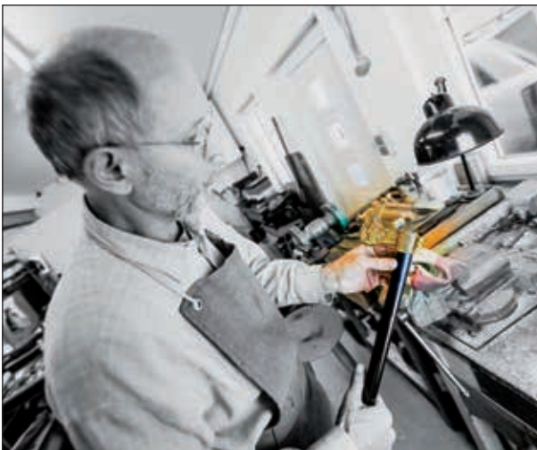
Nach der Endpolitur und dem Einschlagen der Masseinheiten am Stiel ist das Häckel fertig.
