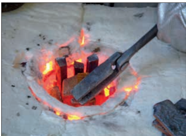
Der Schmelzprozess: Stückiges Metall einsetzen
