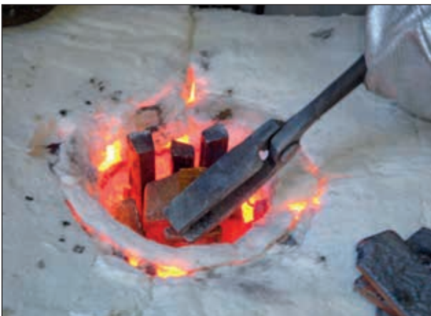
Der Schmelzprozess: Stückiges Metall einsetzen
