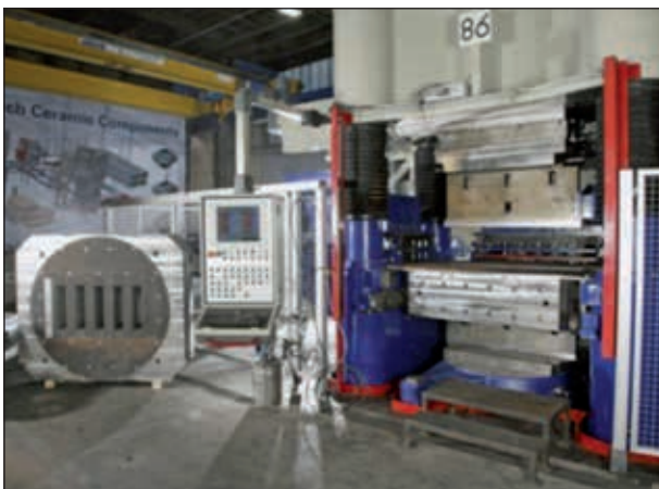
Abb. 15: Vollautomatische prozessgesteuerte hydraulische Presse mit 3.400 t Presskraft 20
