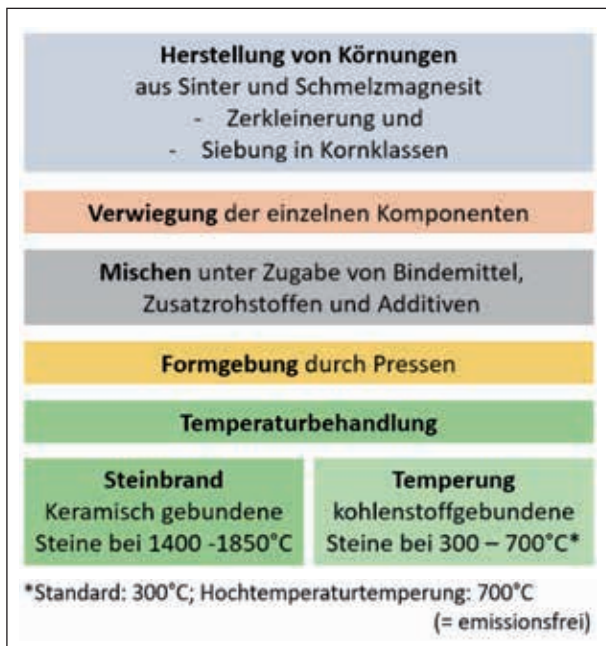
Abb. 14: Schritte der Herstellung von Magnesiasteinen
