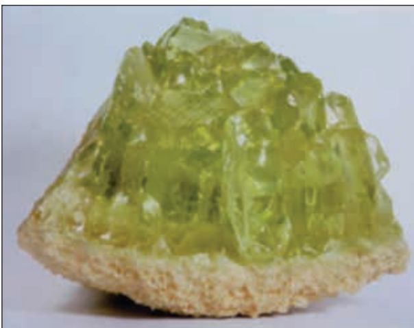
Abb. 13: Schmelzmagnesia mit großen Kristallen
