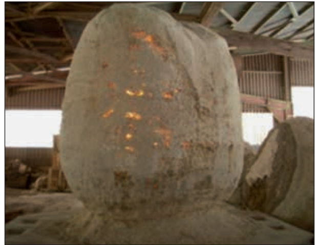
Abb. 12: Lichtbogenofen zur Herstellung von Schmelzmagnesia (linkes Bild); Rohstein oder Kauster werden portionsweise von oben zwischen den Elektroden in einen Stahlmantel eingebracht 20 . Nach dem Schmelzen wird der Stahlmantel gezogen, die anhaftende Kruste entfernt, der Schmelzmagnesiablock (rechtes Bild) gestürzt, zerkleinert und in verschiedene Qualitätsgruppen sortiert.
