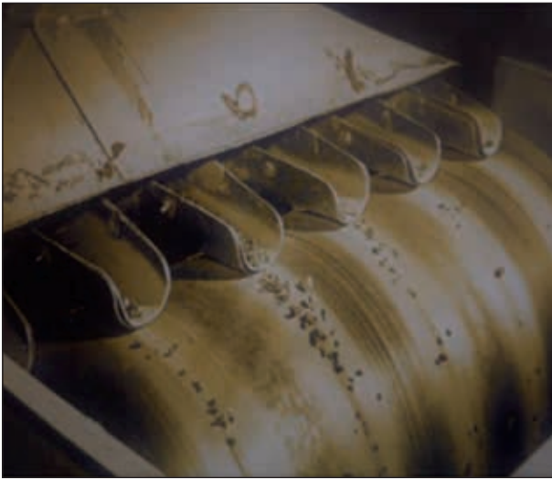
Abb. 6: Magnetscheider zur Abtrennung der unmagnetischen kalkreichen Sinterkörner; die Abtrennung des Sinters erfolgt durch seinen Gehalt an magnetischem Magnesiaferrit.
