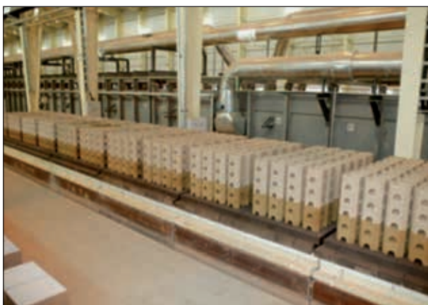
Abb. 16: Prozessgesteuerter Hochtemperatur-Tunnelofen mit einem Besatz von „Glasgittersteinen“ für Glas-Regeneratoren 20
