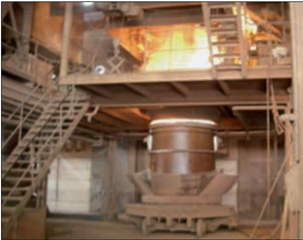
Abb. 12: Lichtbogenofen zur Herstellung von Schmelzmagnesia (linkes Bild); Rohstein oder Kauster werden portionsweise von oben zwischen den Elektroden in einen Stahlmantel eingebracht 20 . Nach dem Schmelzen wird der Stahlmantel gezogen, die anhaftende Kruste entfernt, der Schmelzmagnesiablock (rechtes Bild) gestürzt, zerkleinert und in verschiedene Qualitätsgruppen sortiert.
