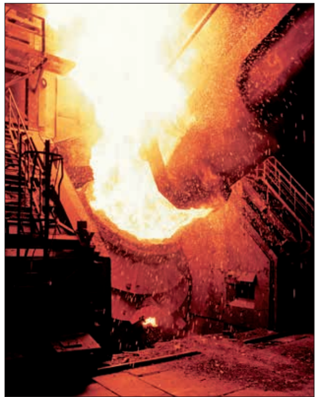
Abb. 3: Beanspruchung eines LD-Konverters (Foto RHI-AG/Wien)
