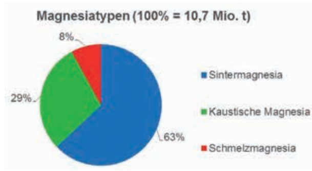
Abb. 7: Produktion von Magnesia nach Modifikationen – natürliche Prozessroute
