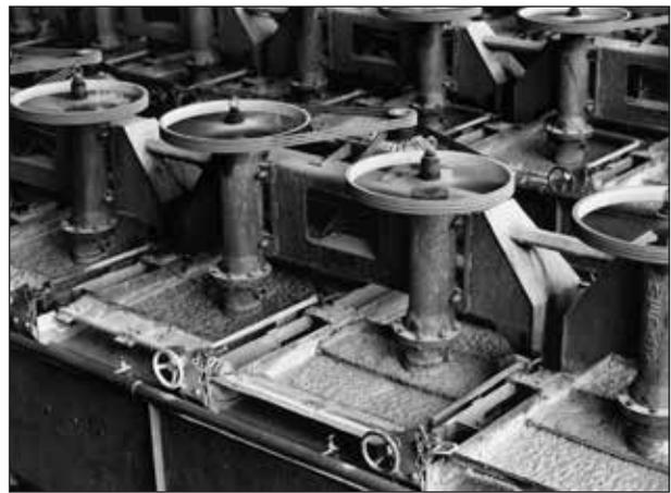
**Abb. 24:** WEDAG-Flotationszellen 1,5 m<sup>3</sup>
