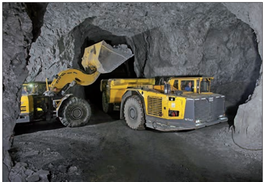
Abb. 15: Fahrlader und Transporter. Ladearbeit im „Hochabbau“ mit Atlas Copco Tiefschauelfahrlader ST14 und Muldentransporter MT 42. (Foto RHI/Brandner)
