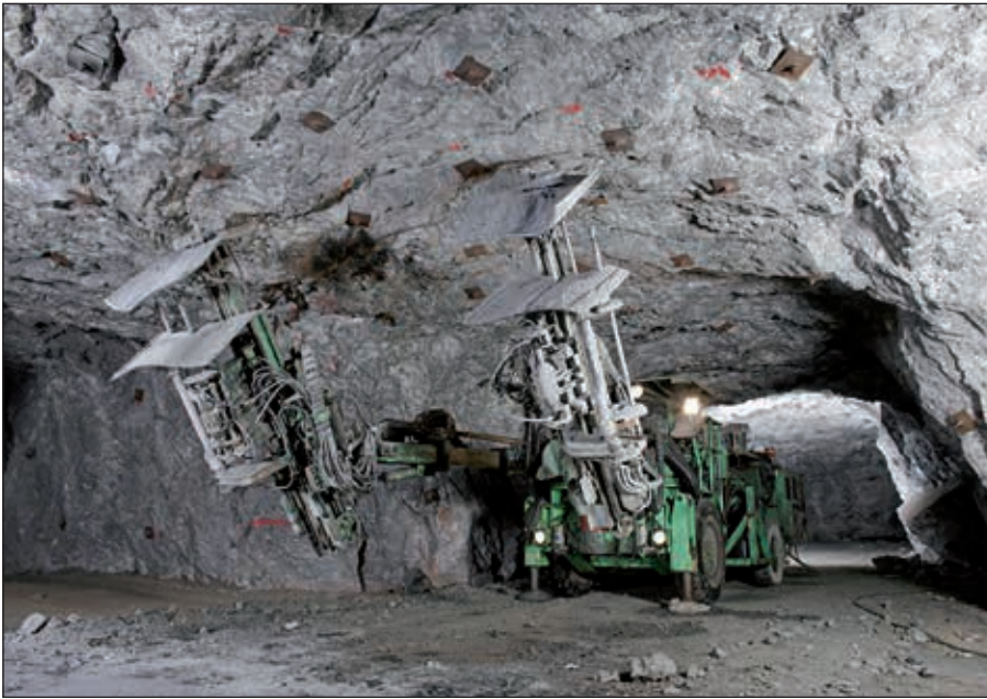
Abb. 14: Fächerbohrwagen. Der im Jahre 1987 beschaffte Montabert Fächer Bohrwagen beim Sprenglochbohren für den Firstverhieb der nächsten Magnesitscheibe in einem „Hochabbau“-Revier. Dieser Bohrwagen ist auch 2017 noch immer im Einsatz. (Foto RHI/Brandner)
