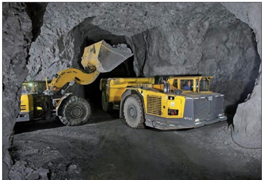
**Abb. 15: Fahrlader und Transporter.** Ladearbeit im „Hochabbau“ mit Atlas Copco Tiefschauelfahrlader ST14 und Muldentransporter MT 42. (Foto RHI/Brandner)
