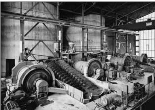
**Abb. 23:** Kugelmühlen 2 x 3 m und Schraubenklassierer
