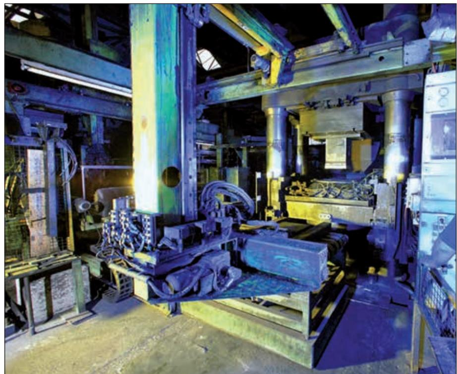
**Abb. 17: Hydraulische Steinpresse**
