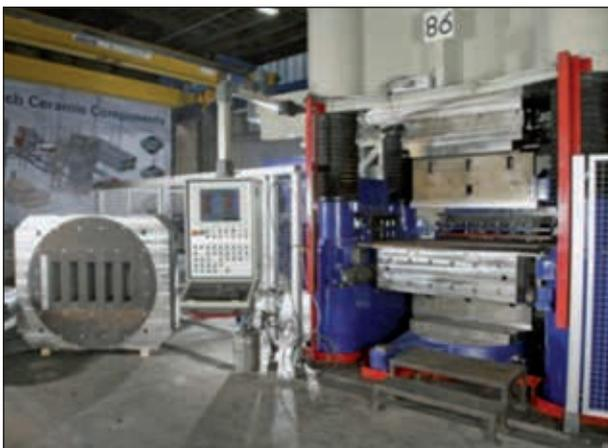
**Abb. 15: Vollautomatische prozessgesteuerte hydraulische Presse mit 3.400 t Presskraft<sup>20</sup>**
