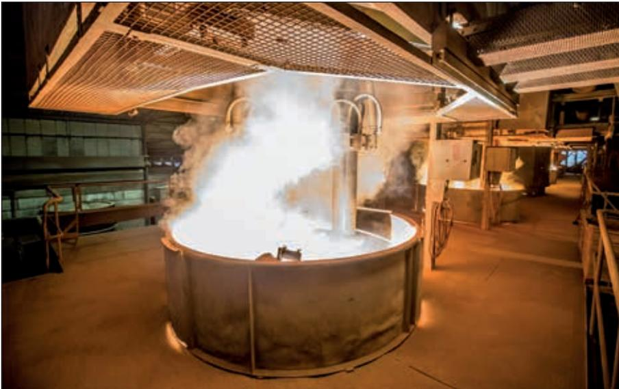
**Abb. 16: Elektroschmelze**
