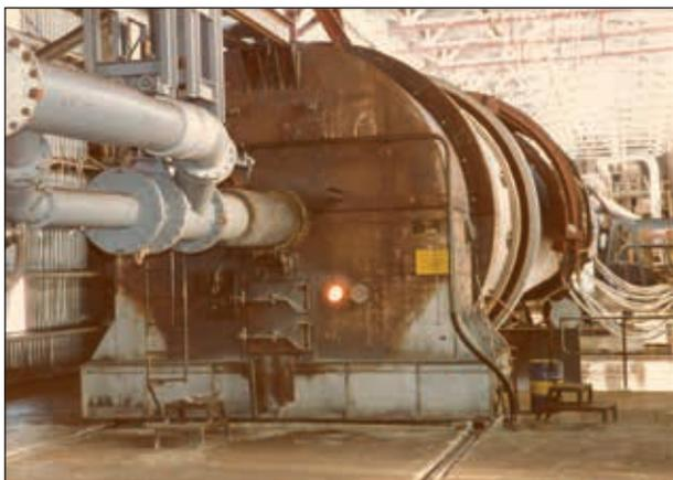
**Abb. 27: POLYSIUS-Drehrohrofen, Länge 80 m. Strahlungsschirme zur Vorwärmung von Flotationswasser (gut erkennbar die Zu- und Ablaufschläuche), 1968**
