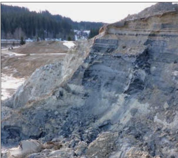
**Abb. 40: Abbau von Klärteichmaterial, Wassergehalt 20–25 %**
