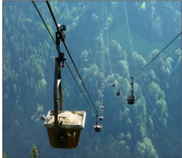
**Abb. 32:** Seilbahn 2, 1000 m Spannweite, 270 m über Grund
