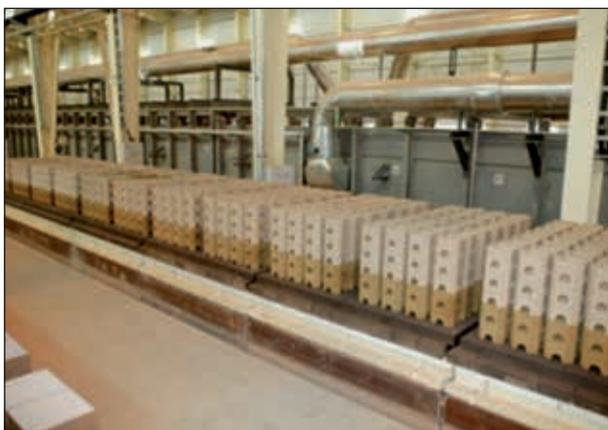
**Abb. 16: Prozessgesteuerter Hochtemperatur-Tunnelofen mit einem Besatz von „Glasgittersteinen“ für Glas-Regeneratoren<sup>20</sup>**
