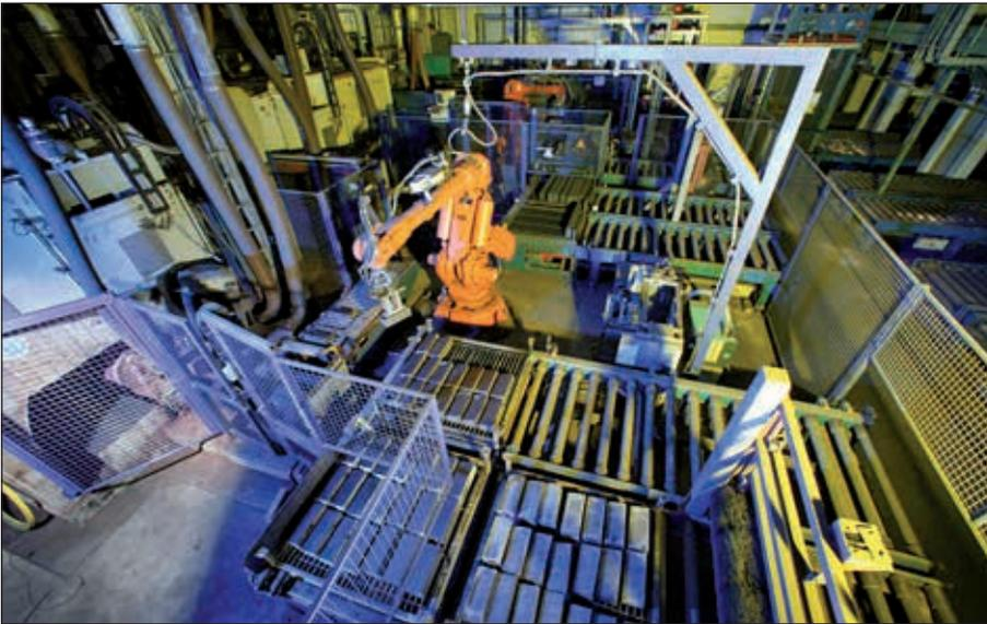
*Abb. 18: Setzroboter im Fräszentrum*
