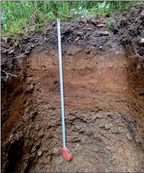
Abb. 5: Das Profil einer Bodenuntersuchung auf der Zosseghalde zeigt Feinkornschichten. Die Proben ergaben hohe Kontamination. Foto Häsitschka
