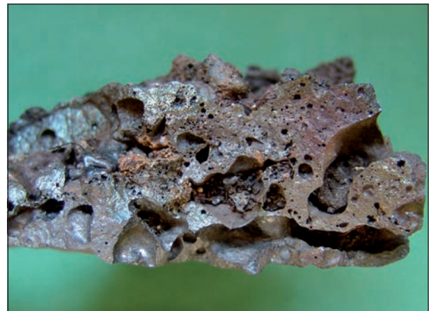
Abb. 9: Die Schlacke vom Stuckofen
