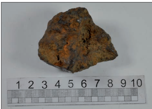
Abb. 1: Makroskopische Aufnahme der römerzeitlichen Roheisenprobe aus Windischgarsten/Oberösterreich, Gewicht: 152,2 g
