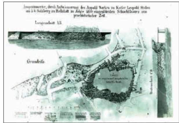
Abb. 13: Zerstörte Werksanlage durch eingedrunenes Tagmaterial
