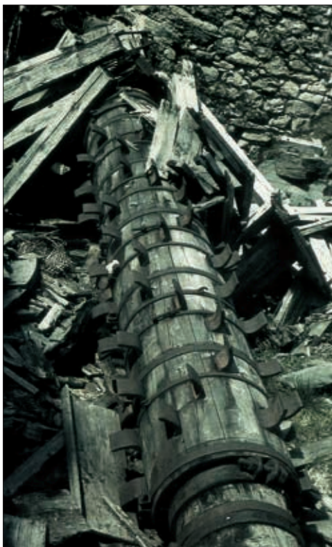
Gold- und Silberbergbau Radhausberg. Reste der Erzaufbereitungsanlage beim nicht mehr vorhandenen Hieronymus-Berghaus; „Daumenwelle“ für das Heben der Pochwerksstempel. Anonyme Aufnahme ca. 1955
