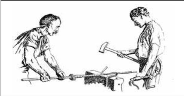
Abb.5a: „Wickeln“ eines Gewehrlaufes<sup>32</sup> aus Vierkantstäben\*)
