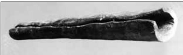
Abb. 7a: Laufabschnitt, aus einer rechteckigen Platine gerollt, mit stumpfer Naht für die Verschweißung vorbereitet<sup>35\*</sup>)
