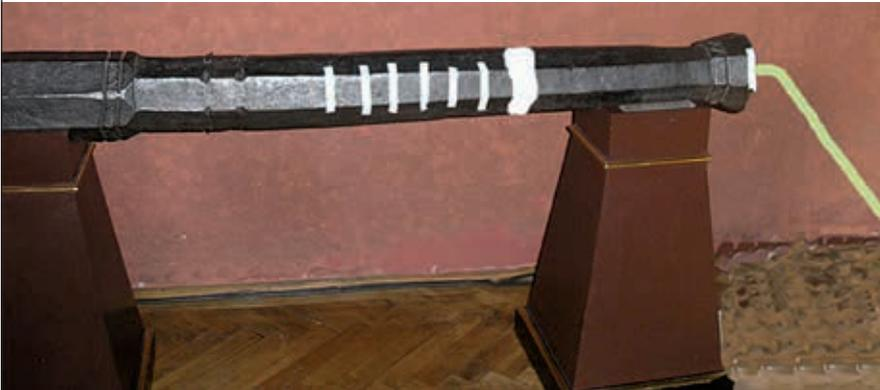
**Abb. 10: Bleibüchse im Heeresgeschichtlichen Museum in Wien. Prüfung mit dem Isotop Iridium-192. Die weißen Klebestreifen markieren die Platzierung der sieben Filme**
