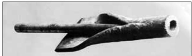
Abb. 7b: Laufabschnitt; die stumpf geschweißte Naht ist im Dornschweißverfahren verbunden<sup>36\*</sup>)
