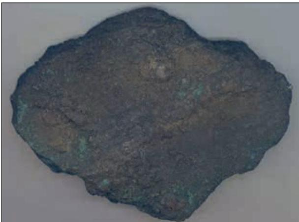
Abb. 10: Bei der montanarchäologischen Grabung am Verhüttungsplatz Versunkene Kirche/KG Schwarzenbach/OG Trieben geborgener urnenfelderzeitlicher mehrschichtiger Schwarzkupferkuchen; Maßstab 1:1,2.
