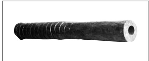
Abb. 6b: Teilweise verschweißter Lauf, der aus einer längsgeschweißten und dann tordierten Platine erzeugt wurde<sup>34\*</sup>)
