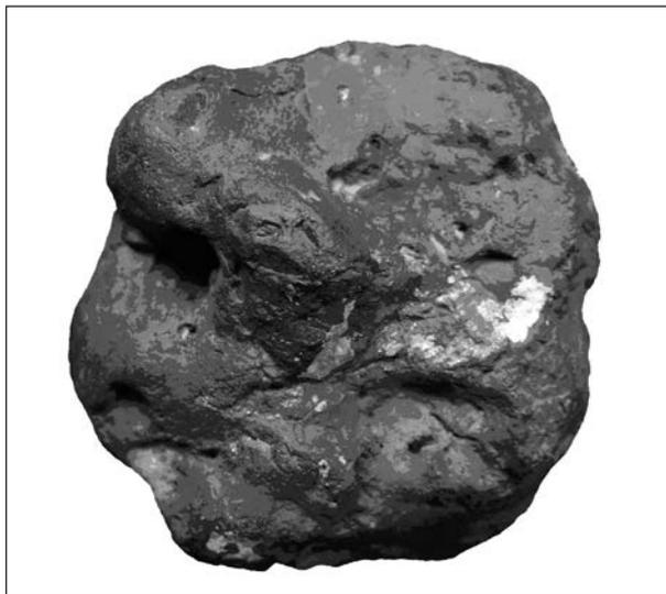
Abb. 2: Fundort Zölzboden. Eisenerz mit angeschmolzenen bzw. teilreduzierten (?) Randbereich; Größe (Durchmesser) ca. 40 mm, Gewicht 84 g. Fund und Aufnahme: J. Friml, April 2010
